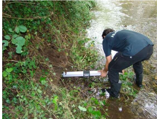
Figura 6. Análisis, mediante resistógrafo, del estado de deterioro de los troncos utilizados en un entramado de madera en el río Artía (Irún, Guipúzcoa). Foto: Guillermo Tardío
